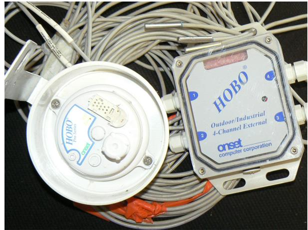
**Figura 1:** Colectores de datos con sensores HOBO® (Onset Computer Corporation). A la izquierda modelo Pro Series con sensores de temperatura y humedad relativa del aire internos. A la derecha, modelo "H8 Outdoor/ Industrial 4 channel external" con sensores de temperatura externos consistentes de termistores encapsulados en acero inoxidable.
