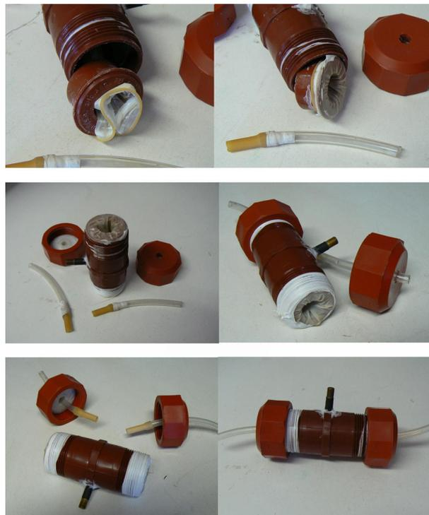
**Figura 5:** Detalles de armado de un conductímetro para segmentos de madera sin corteza (basado en idea original de Spicer y Gartner (1998), aunque modificado para ser confeccionado con elementos económicos y de fácil disponibilidad).
