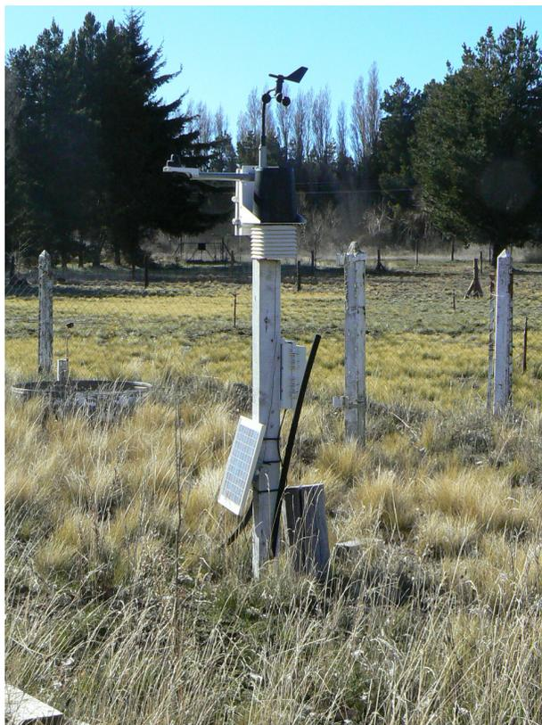
**Figura 2:** Estación meteorológica Davis Instruments modelo Wizard III® la cual consta de sensores para medir la velocidad del viento (anemómetro) y su dirección, precipitación (pluviómetro), radiación solar (radiómetro), y temperatura y humedad relativa del aire.
