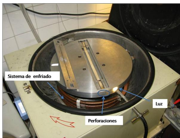
**Figura 6:** muestra de madera colocada en posición de medición y tapa con los pequeños conductos que transportan agua.
