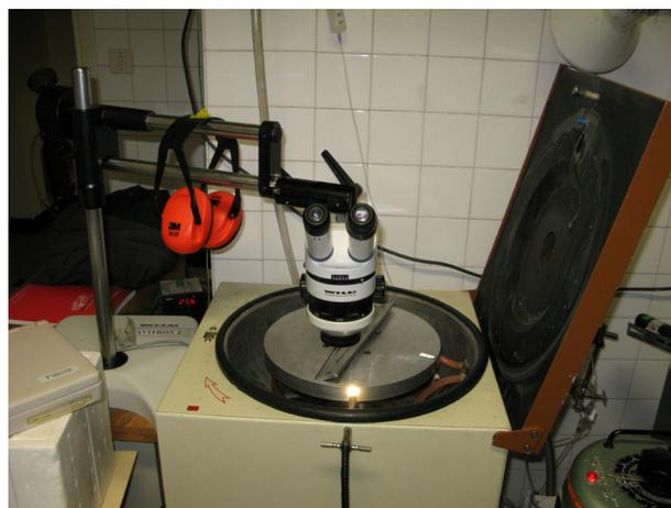
**Figura 4:** Cavitron en el INRA Clermont Ferrand, con lupa binocular.
