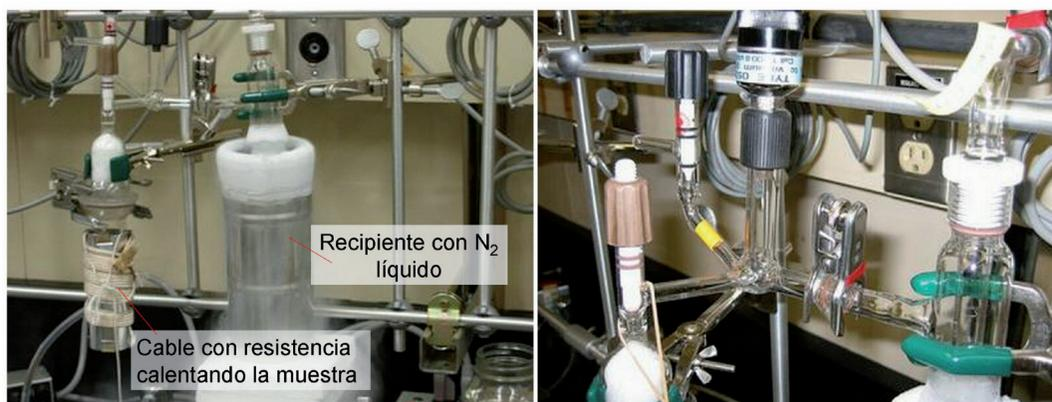
Figura 3: Fotografía de la línea construida bajo el sistema de la EPA. A la izquierda: línea funcionando, con el tubo conteniendo la muestra envuelto en un cable con resistencia para proporcionar alta temperatura, y el tubo colector sumergido en  $N_2$  líquido. A la derecha: detalle de uniones de vidrio con válvulas plásticas y conector del vacuómetro.
