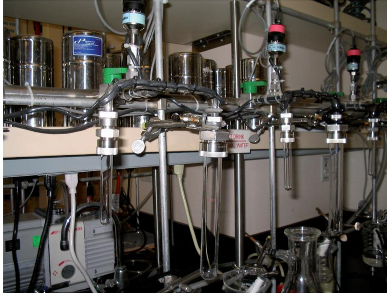
**Figura 4:** Línea de vacío construida en el laboratorio SIRFER a cargo del Dr. Jim Elheringer, University of Utah. En el tubo más grande de la derecha es donde se coloca la muestra original, y en el tubo pequeño es donde se colecta el agua extraída de la misma. El primero se sumerge en un vaso de precipitado con agua hirviendo, y el segundo en un termo con N<sub>2</sub> líquido. (Fotografía tomada por M.E.Fernández en el laboratorio de referencia).
