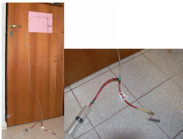
**Figura 2:** Conductímetro de un solo canal, basado en el método de la pipeta
