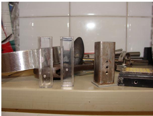
**Figura 7:** Los dos tubos con las perforaciones a distintas alturas y el « molde » para realizarlos pues se rompen con facilidad.
