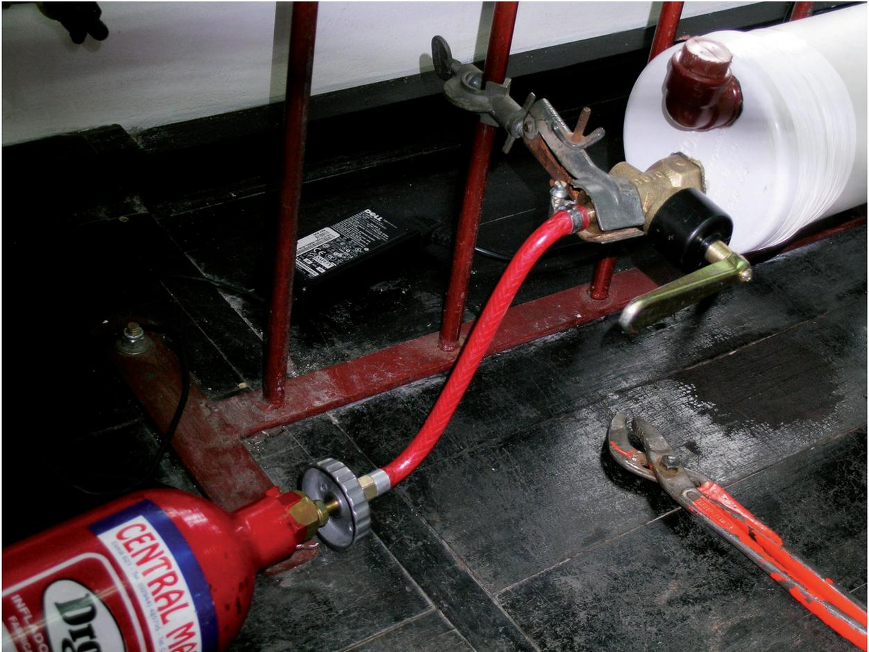
**Figura D:** Fotografía mostrando la conexión completa del perfusionador al tanque de gas y (particularmente en este caso) al sistema de confección de curvas de vulnerabilidad a la cavitación.
