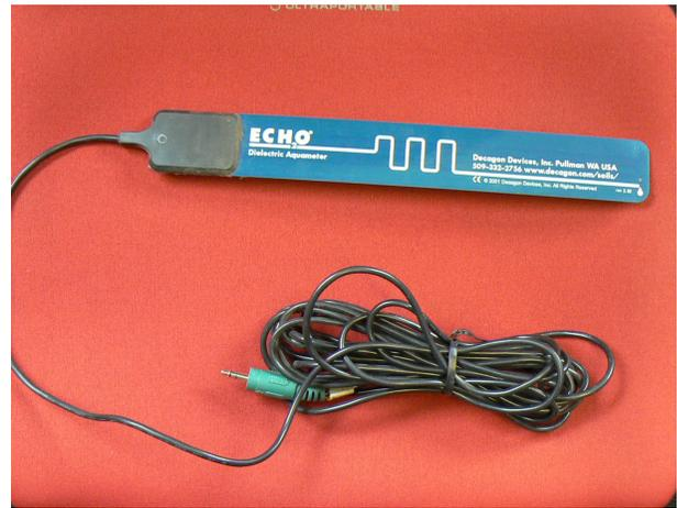
**Figura 5:** Sensor ECH<sub>2</sub>O® de Decagon para determinar el contenido de agua en el suelo basado en el principio FDR.
