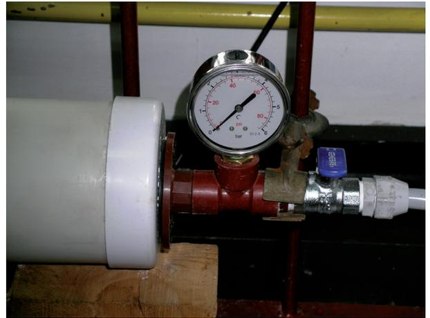
**Figura B:** Fotografía mostrando la conexión de la llave de paso a la tapa de PVC y la conexión de dicha llave de paso a la cámara de pelota, permitiéndose el inflado y desinflado de esta última.
