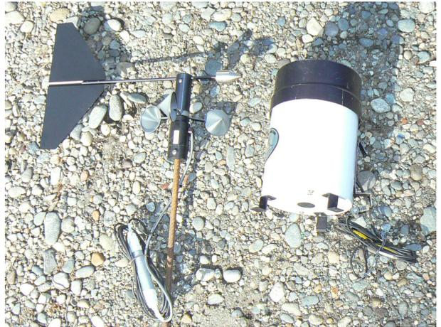
**Figura 6:** A la izquierda se observan las copelas del anemómetro y la paleta del sistema para determinar la dirección del viento (sistema mecánico). A la derecha se muestra un pluviómetro, ambos modelos HOBO® de Onset.
