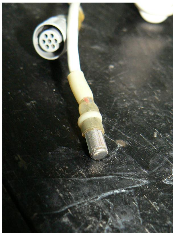
**Figura 4:** Detalle de la cápsula de malla de acero inoxidable de la sonda Wescor que envuelve a las termocuplas para la determinación de la temperatura y potencial agua del suelo. Al fondo de la imagen se observa el conector (sonda Wescor Inc.).
