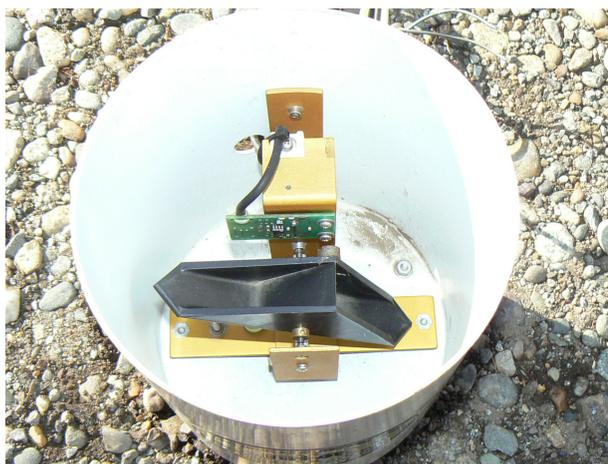
**Figura 8:** Detalle del interior del pluviómetro HOBO®. Se observa el balancín y el circuito electrónico que mide la frecuencia de balanceo.
